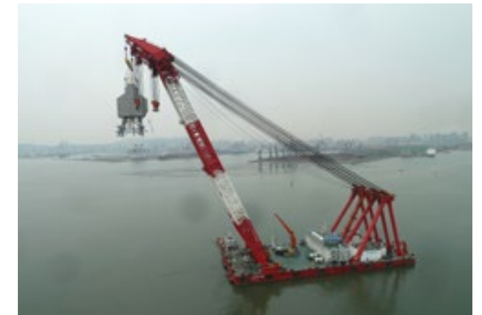
Her henger «dup'en» (toppen av boretårnet) i krana. Here the "dup" (the top of the drilling tower) is hanging in the crane:
