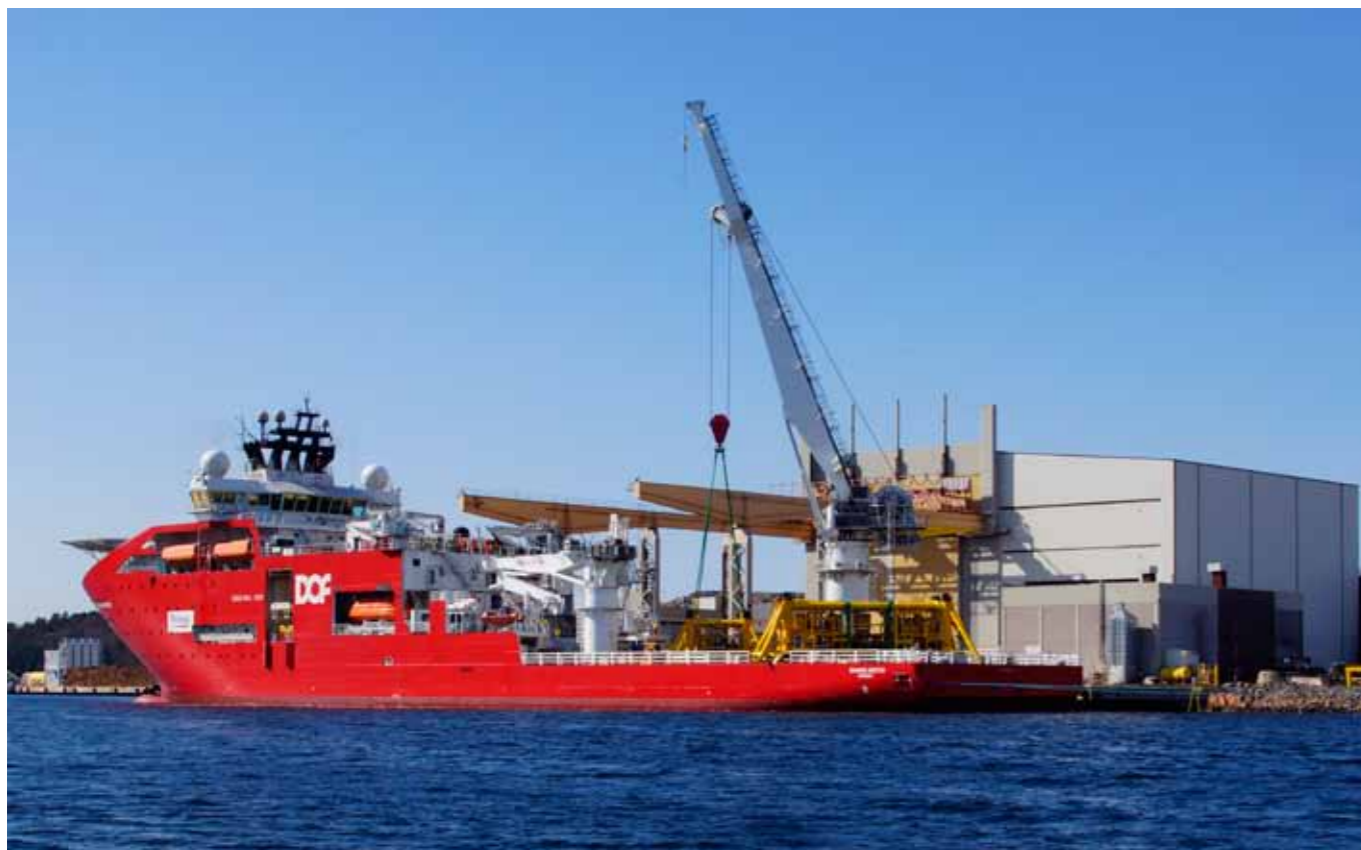
Subsea strukturer ferdigstilt ved Nymo Eydehavn blir lastet om bord for utskipping til Alvheim-feltet. Loading of subsea structures completed at Nymo's facility at Eydehavn for transportation to the Alvheim field. Foto/Photo: J P Lehne
